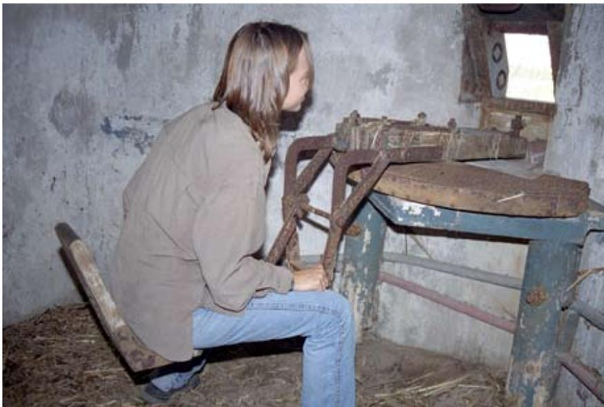
Пулеметный станок противодесантного дота
