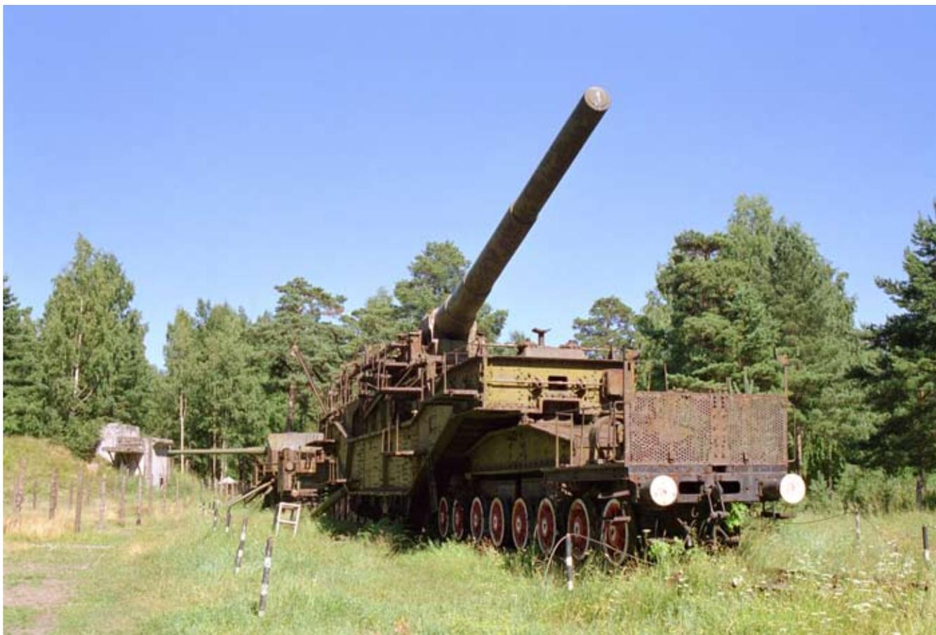
Транспортер ТМ-3-12 с 305-мм орудием
