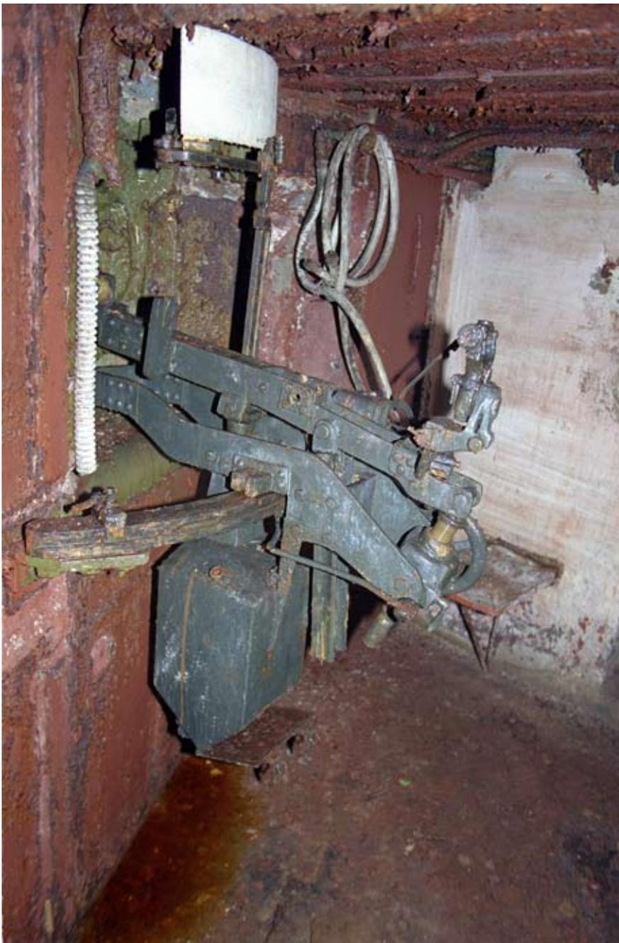
Пулеметный станок с системой слепого прицеливания
