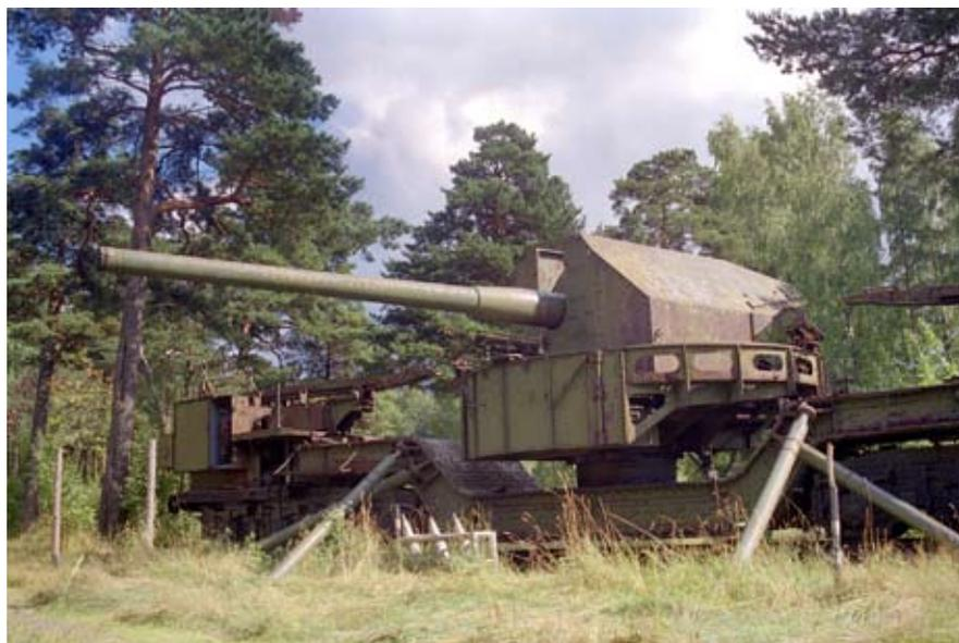
Транспортер ТМ-1-180 с 180-мм орудием
